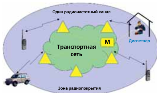
Рис. 5. Схема построения сети Simulcast.
