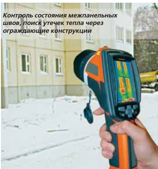
Контроль теплоизоляции бесконтактным способом
