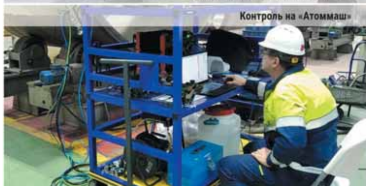
Отработка методики для контроля «Золотых стыков» газопровода «Северный поток – 1»
