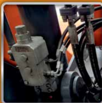
Гидрозамок на гидроцилиндре подъёма стрелы
