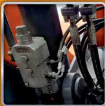
Гидрозамок на гидроцилиндре подъёма стрелы
