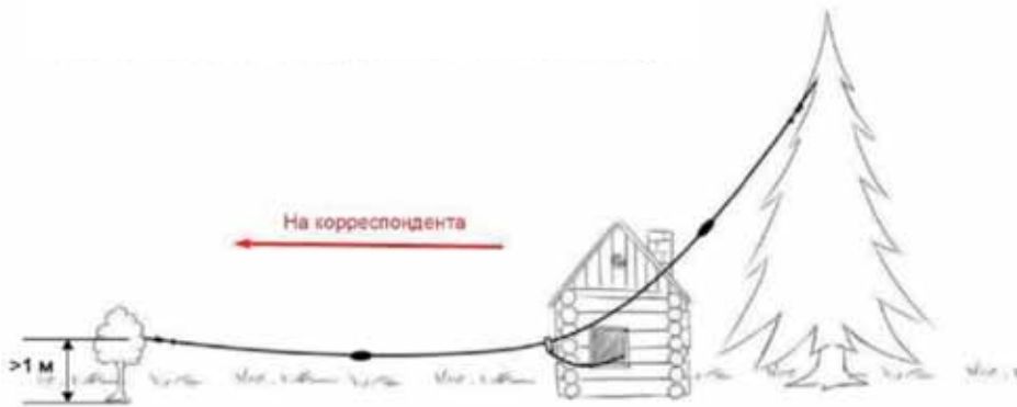
Рис. 4 Вариант развёртывания антенны в виде наклонного луча
