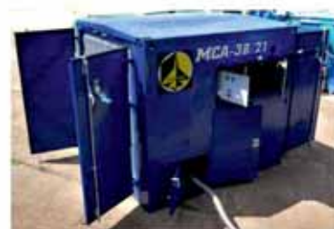
Газоразделительный блок азотной установки
