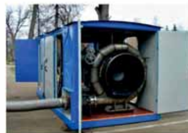
Газотурбинная компрессорная установка ГТКУ М10/21
