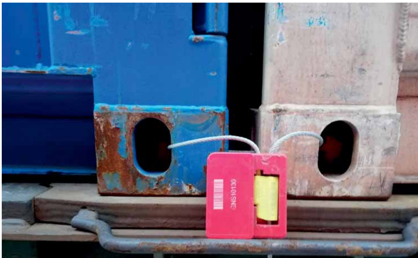
Электронная навигационная пломба «БИГЛОК» производства АО «ИПК «СТРАЖ» в период перевозки по маршруту ст. Брест – ст. Карталы-1, закреплённая через отверстия, предназначенные для крепления контейнеров на фитинговых платформах
