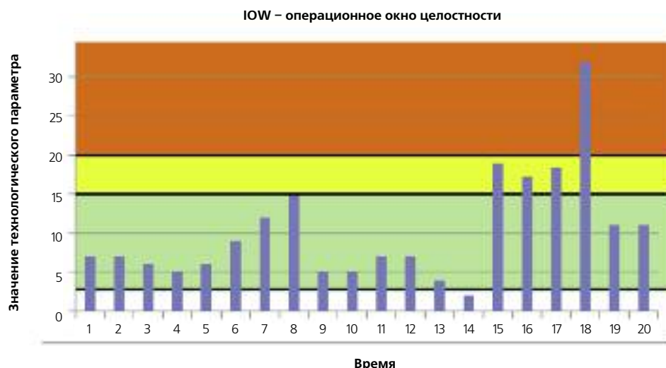
Рис. 1. Операционное Окно Целостности (введено в API 584) – используется в динамическом RBI для учёта накопления повреждённости при повышенных (жёлтая зона) и критических (красная зона) значениях технологических параметров.
