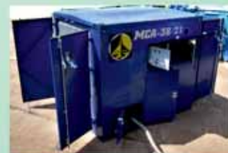
Газоразделительный блок азотной установки
