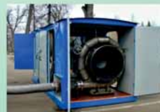
Газотурбинная компрессорная установка ГТКУ М10/21
