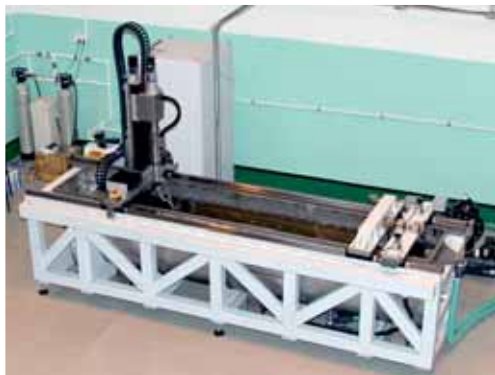
Установка АСНК-ВАЛ для контроля заготовок валов авиационных двигателей. АО «ПМЗ»
