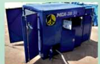
Газоразделительный блок азотной установки
