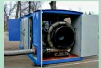
Газотурбинная компрессорная установка ГТКУ М10/21
