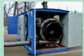
Газотурбинная компрессорная установка ГТКУ М10/21
