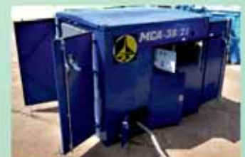
Газоразделительный блок азотной установки
