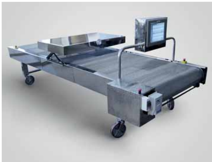
Автоматизированная линия контроля чистоты РЗСК-01 – радиометр контроля гамма-, бета-активных загрязнений спецодежды.
