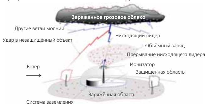
Рис. 1. Предотвращение попадания молнии с помощью Dissipation Array® System компании LEC.
