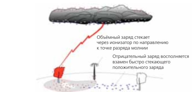
Рис. 5. Заряд уходит в молниевый канал. Установка возвращается в нейтральное состояние.
