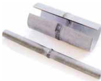
Рис.1. Внешний вид сварного шва на диффузионно оцинкованных трубах
