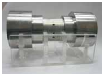
Магнитная система дефектоскопа для контроля стальных труб
