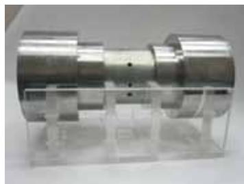
Магнитная система дефектоскопа для контроля стальных труб
