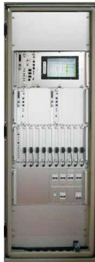
Пример построения одного комплекта оборудования подсистемы АЗ-ПЗ и УСБИ, совмещающего функции АЗТП, АЛОС, АФАК, АСП, АРОМ, для УСБ АЗ-ПЗ и АЗТП, АЛОС для УСБИ
