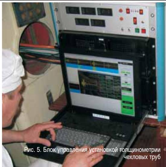
Рис. 5. Блок управления установкой толщинометрии чехловых труб
