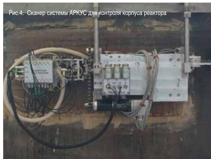
Рис. 4. Сканер системы АСК для контроля корпуса реактора
