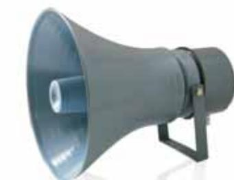
имеется трансформатор с напряжением питания 30/120/240В. При изготовлении магнитной системы используется редкоземельный магнит. В рупорном громкоговорителе путём сдвига частот до 250Гц (рабочий диапазон частот 250...8000Гц) удалось добиться разборчивости и «окраса» голоса.
