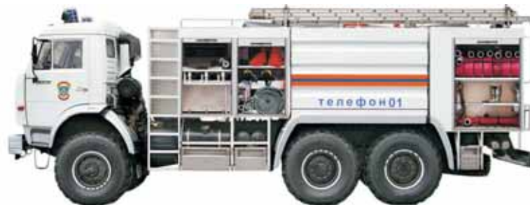
АПСР – автомобиль приготовления специальных растворов
