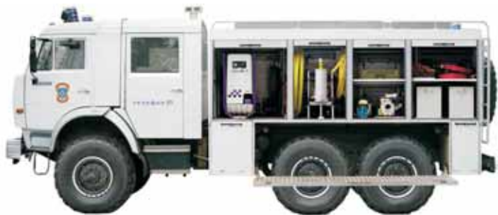
САЛЗ – специальный автомобиль оценки загрязнений и проведения работ по ликвидации химического и биологического загрязнения
