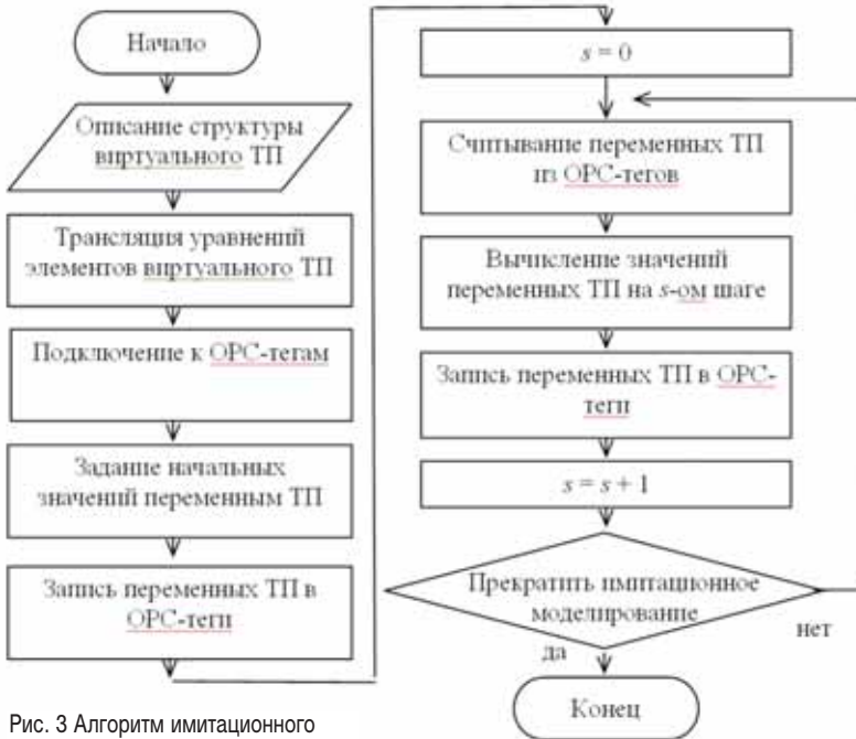
Рис. 3 Алгоритм имитационного моделирования виртуального ТП.
