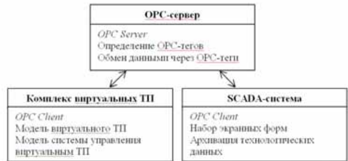
Рис. 4 Схема взаимодействия комплекса со SCADA-системой.
