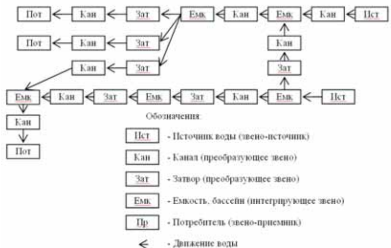
Рис. 5 Структура виртуального ТП водораспределения в ГМС.
