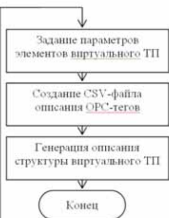
Рис. 2 Алгоритм конструирования виртуального ТП.
