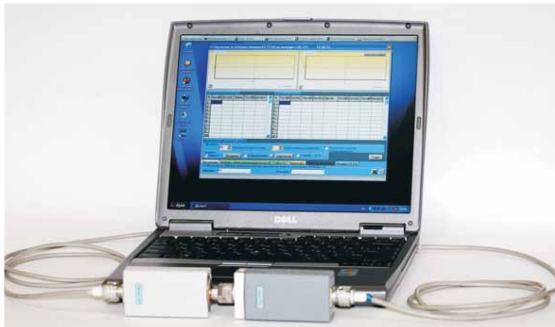
Ваттметр в составе интеллектуального датчика малого уровня мощности с ВЧ калибратором и персональным компьютером
