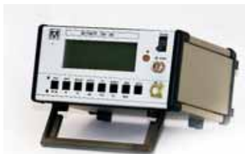
Блок управления и индикации для работы ваттметра (-20°C – 50°C)
