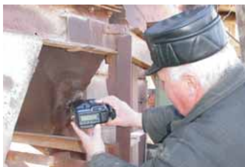
Контроль теплоизоляции бесконтактным способом
