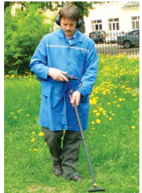
Поиск коммуникаций на месте предполагаемых земляных работ
