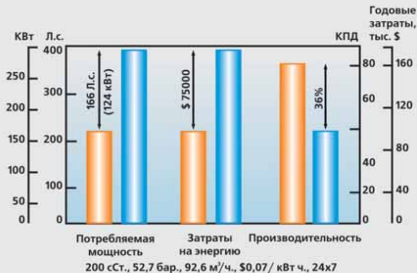
рис. 1. Сравнительные характеристики винтовых (■) и центробежных (■) насосов
