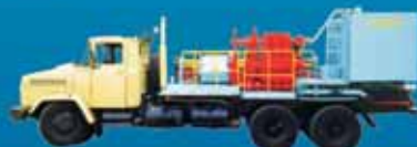
Многофазная дожимающая бустерная насосно-компрессорная установка типа УБ для нагнетания газов и газожидкостных смесей.
